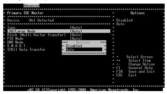
打开/关闭LBA (Logical Block Addressing)/Large模式。如果设备支持此模式可设置为 "Auto" 打开LBA 模式, 否则可设置 "Disabled" 关闭LBA 模式。
