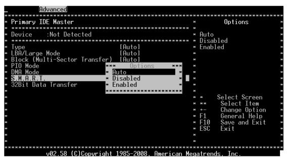
SMART代表灵巧的、可监视的、可分析的和可报告的技术。他允许BIOS使用SMART协议 通过网络报告服务器的系统信息。
