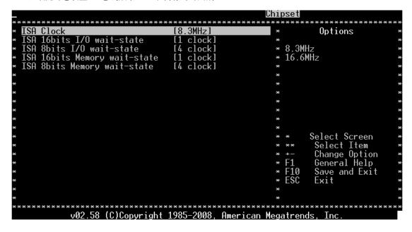
**温馨提示:** "ISA Clock"选项设置ISA总线的工作频率,标准ISA总线工作频率为8.2MHz(BIOS默认),可调16.6MHz。 "ISA 16bits I/O wait-state" / "ISA 8bits I/O wait-state"选项设置ISA总线上16位/8位I/O设备的等待时间,有些ISA总线设备工作模式比较慢,在此选项可设置工ISA总线的I/O等待周期。"ISA 16bits Memory wait-state" / "ISA 16bits Memory wait-state"选项设置ISA总线上16位/8位内存区等待时间。
