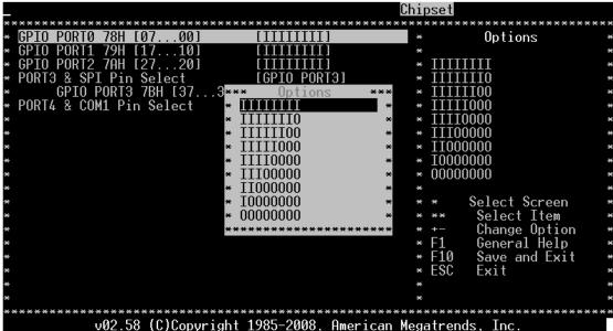
允许您设置其功能和传感器可其他设备类型。如果没有此类设备,可直接扩展GPIO功能。如上图 "I"表示其信号位为输入(Input)模式,"O"表示其信号位为输出(Output)模式。此选项设置好后,主板开机就会将相应的GPIO位初化您设置工作模式。
