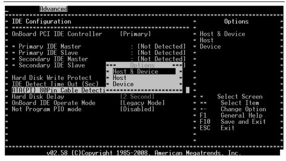
使用高密80针ATA线缆以保证Ultra ATA/66, Ultra ATA/100 及Ultra ATA/133的高速运转。 常规40针线缆无法实现其高速运转。
